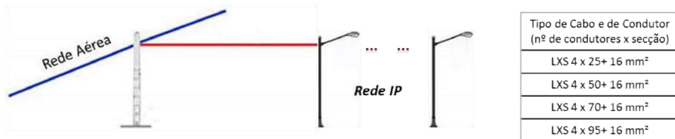
Figura 8.6 - Ligação através de linha aérea da rede de iluminação pública.
